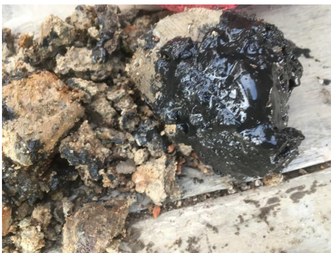
Figur 4. Fyllnadsmaterial i 19BH1 med inslag av byggavfall och okulära tecken på petroleum mellan 4,7-5,0 m.u.my.
