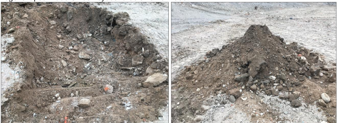
Figur 9. Fyllnadsmassor i provpunkt PG 12 (0-0,5 m.u.my.) till vänster och det betydande inslaget av tegel-, armeringsjärn- och stenrester i fyllnadsmassorna i ett flertal provpunkter i egenskapsområdena A, B och C samt provpunkterna PG9, PG13 och PG16 syns till höger i figuren.
