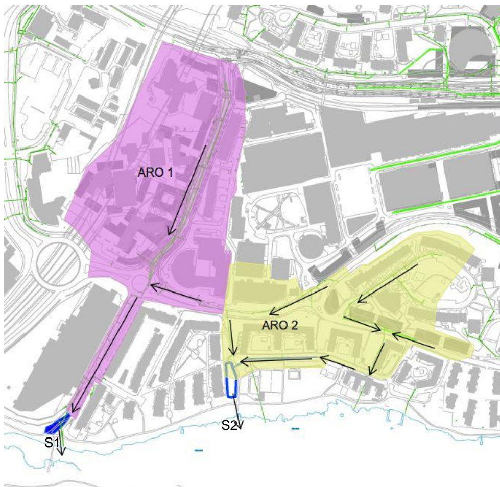
Figur 26. Sicklasjön - ny dagvattenhantering, delavrinningsområden och dagvattenreningsanläggningar
