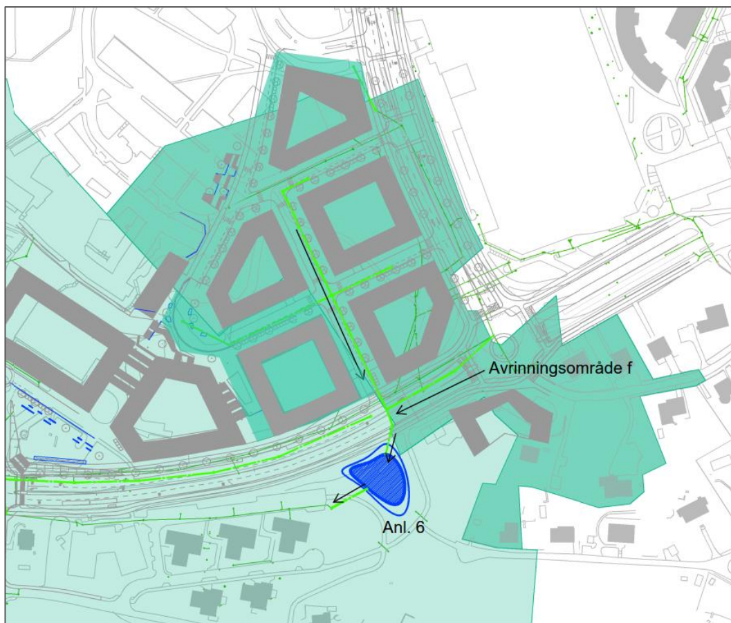
Figur 15. Avrinningsområde f med dess dagvattenreningsanläggning - damm Nya gatan.
