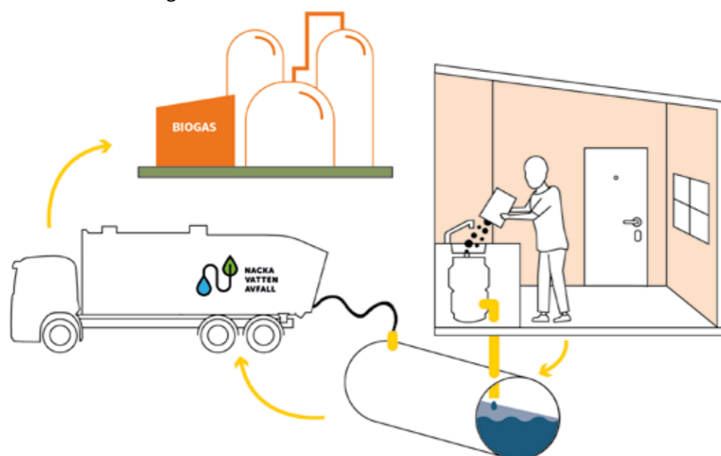
Matavfallskvarn till tank.
