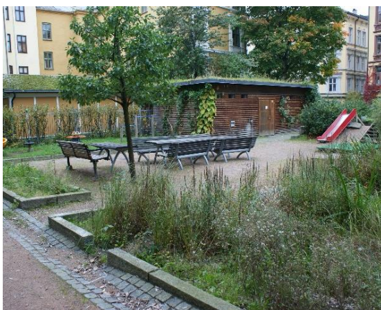
Figur 6. Bilderna visar exempel på seriekopplade regnbäddar på kvartersmark samt exempel på överfall och dämmen. Rännor kan avleda dagvattnet till regnbäddar men även fungera som bräddning i ett seriekopplat system.
