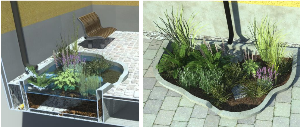
Figur 5. Illustrationer över nedsänkt regnbädd som kan ta emot dagvatten från tak och markytor. Inflödet sker via stuprör och släpp i kanten. Överskottsvatten avleds via dränering och bräddbrunn.
