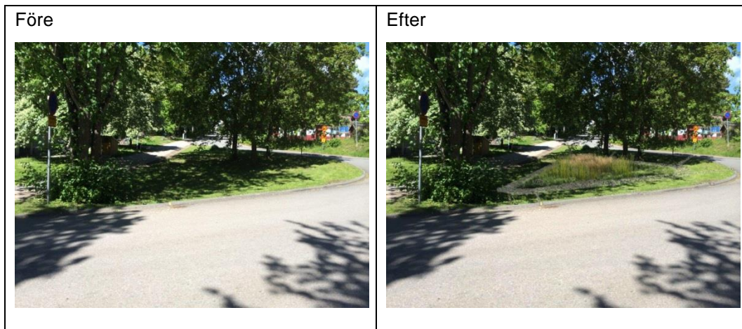
Figur 15: Exempel på dagvattenhantering där en befintlig grönyta sänks ner och utnyttjas för rening och fördröjning av dagvatten från Blomstervägen (nr 12)
